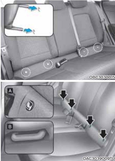
[A]: ISOFIX-kiinnityspisteen sijaintimerkintä, [B]: ISOFIX-alakiinnityspiste
